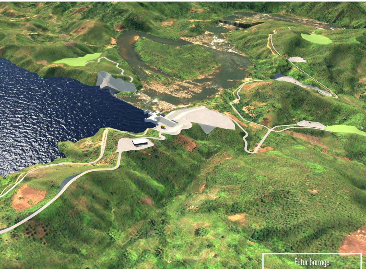
4,1 km, un chenal à l'air libre de 75 m pour rejoindre le fleuve, et un seuil de démodulation au droit du futur ouvrage de franchissement de l'Ivondro (pont). Les infrastructures associées telles que des routes d'accès, bases vie, installations techniques, un pont de 150 m, un poste de transformation au niveau de l'usine et une ligne d'évacuation avec une connexion au poste existant de Toamasina.
